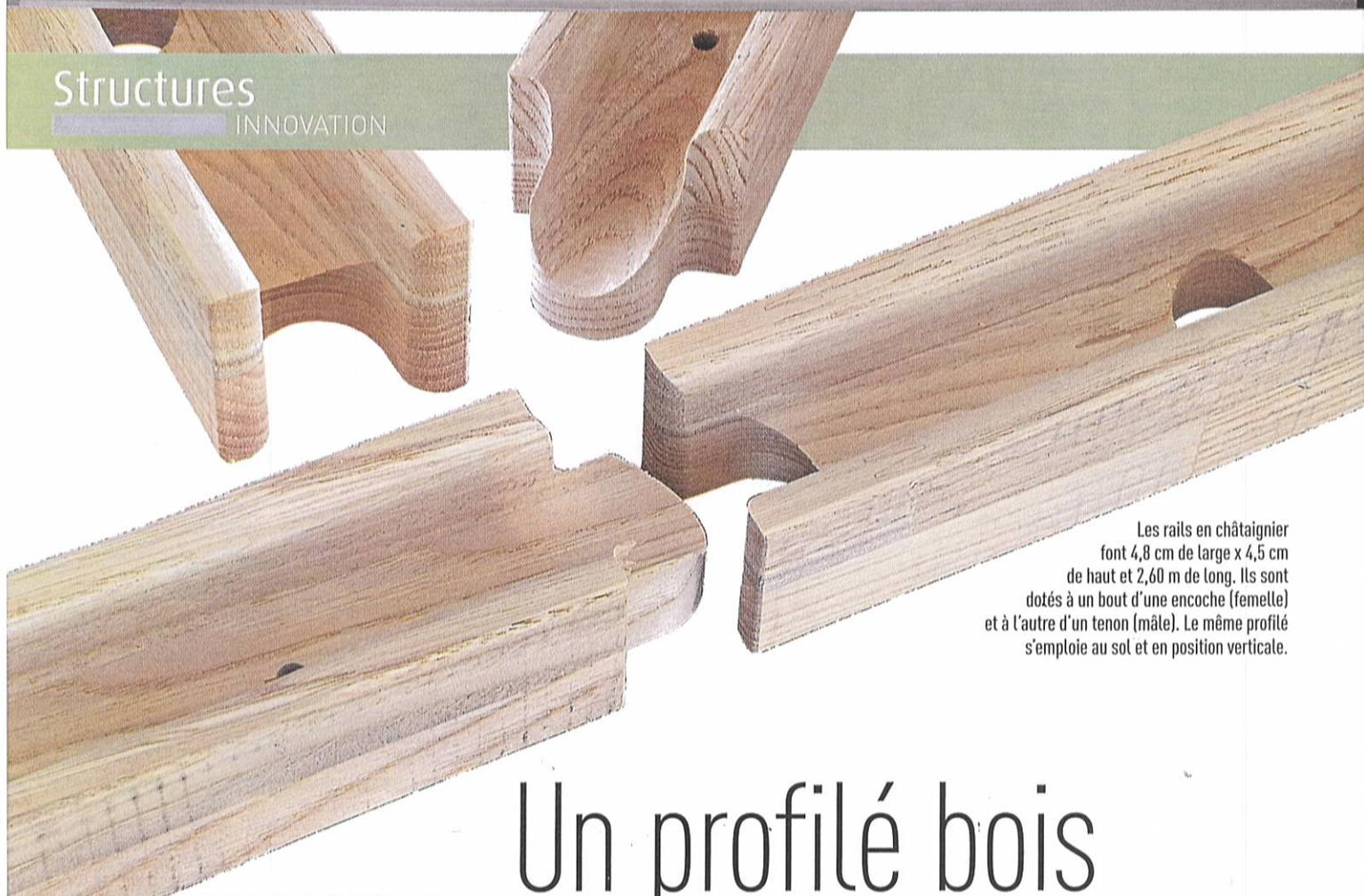
Les rails en châtaignier font 4,8 cm de large x 4,5 cm de haut et 2,60 m de long. Ils sont dotés à un bout d'une encoche (femelle) et à l'autre d'un tenon (mâle). Le même profilé s'emploie au sol et en position verticale.
